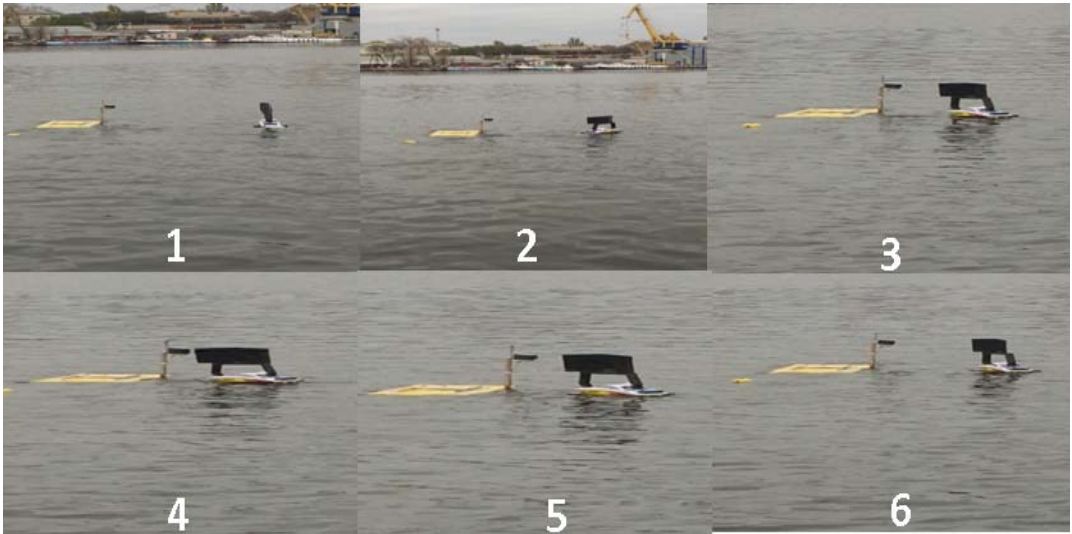
Рисунок 5.10 – Фотофрагменти морських натурних випробувань САК АНПА як «агента» групи: 1 – обидва макети АНПА відділені один від одного і рухаються з заданими швидкостями; 2 – макет АНПА-1 і макет АНПА-сусіда перебувають у зоні притягання, тому САК макетом АНПА-1 реалізує режим когезії (макет АНПА-1 наближається до макета АНПА-сусіда); 3 – макети АНПА розташовані занадто близько; 4 – макети розташовані у зоні небезпечного зближення; САК макета АНПА-1 змінює курс апарата на віддалення від макета АНПА-сусіда; 5 – макет АНПА-1 віддалився від макета АНПА-сусіда і режим адгезії виконано; 6 – безпечний режим, коли обидва макети почали вільно рухатись заданими курсами та з заданими швидкостями
