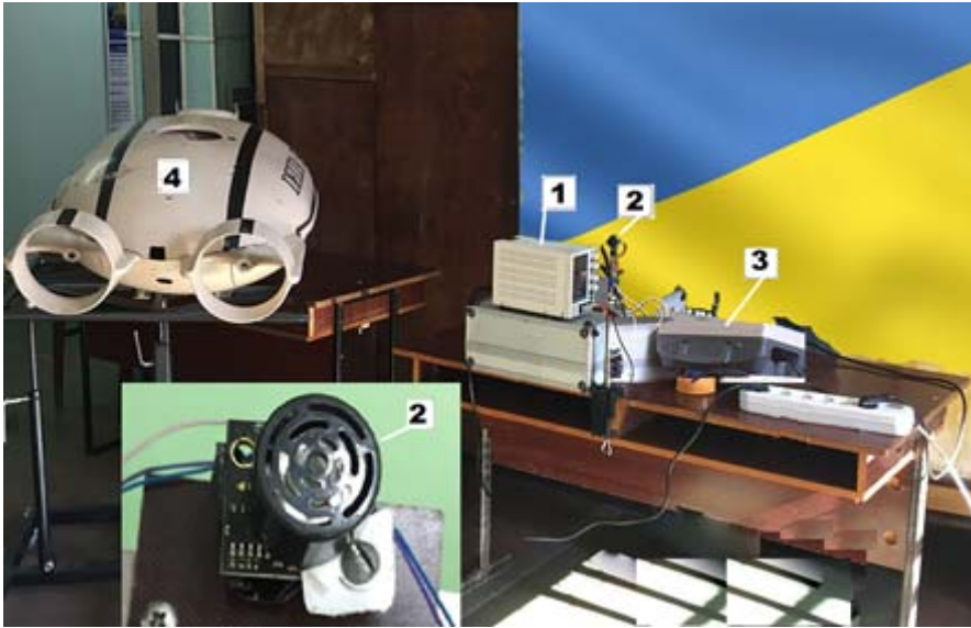
Рисунок 5.5 – Стенд для визначення діаграми спрямованості ультразвукових далекомірів: 1 – блок живлення; 2 – ультразвуковий далекомір моделі MB 1003-EZ0; 3 – осцилограф; 4 – макет АНПА-1
