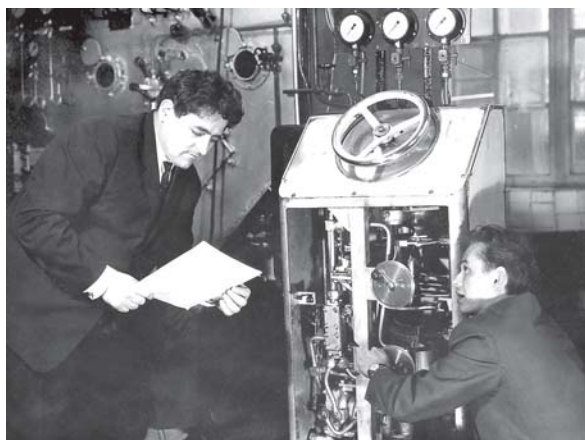
1967 р. Доцент Рижков С. В., викладач Янов Л. І. проводять наладку автоматики суднового котла
