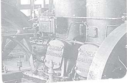
1956 р. Завідувач теплотехнічної лабораторії Артемов Г. А. за підготовкою калоризаторного двигуна для проведення лабораторної роботи
